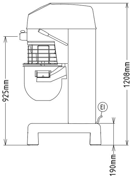
EI = Conexión eléctrica (energía)
